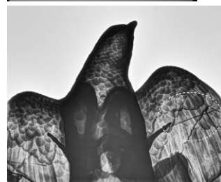
図12 鷹8のX線透過像 胴部に土台構造が見られ、翼部にはワイヤーの影が写る（図中点線内）
