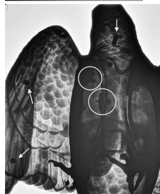
図11 鷹6のX線透過像 パーツをとめている突起物（図中矢印）とパーツをとめているネジとボルト（○印）
